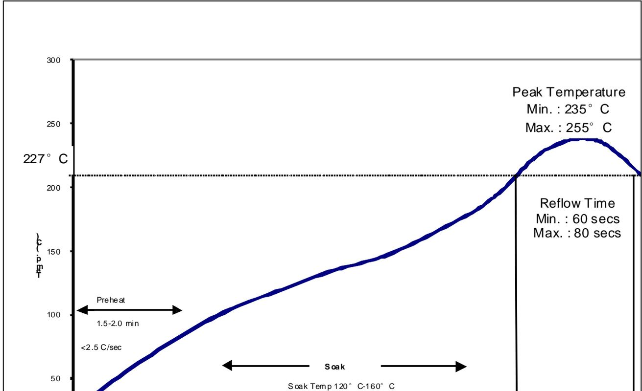
Preheat Zone - 预热区，也称为升温区，用以提升PCB的温度以达到需要的恒定温度。在预热区，PCB的温度以不超过2.5°C/sec的速度持续升高。回流炉预热区的长度通常占整体长度的25-33%。
